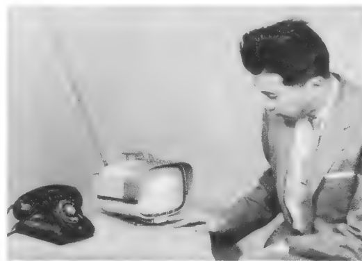
Volltransistor-Fernsehempfänger Sony 8-301 für Batteriebetrieb und Netzanschluß 110 V
