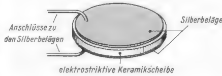
Bild 1. Aufbau eines elektrostriktiven Elements
